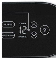
Fig. 3 Función del Temporizador
